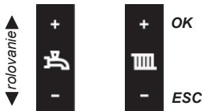
Čerpadlo je z výroby nastavené na automatický chod. Znamená to, že čerpadlo sa zapne, keď vznikne dopyt po teple alebo teplej vode. V prípade potreby je možné nechať bežať čerpadlo nepretržite. Na to sú nutné nasledujúce úkony:
